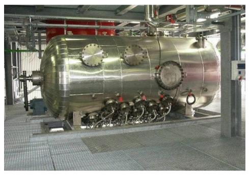
**Figure 73.** Paddle pyrolysis reactor used by Choren (<u>http://www.fnr-server.de/cms35/fileadmin/</u> <u>allgemein/pdf/veranstaltungen/BtL\_Berlin\_2008/4\_Blades.pdf</u>, date accessed: Nov. 13, 2010).
